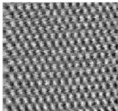
Рис.5. Исходное изображение квадратного участка поверхности со стороной 40 Å, полученное туннельным микроскопом.
